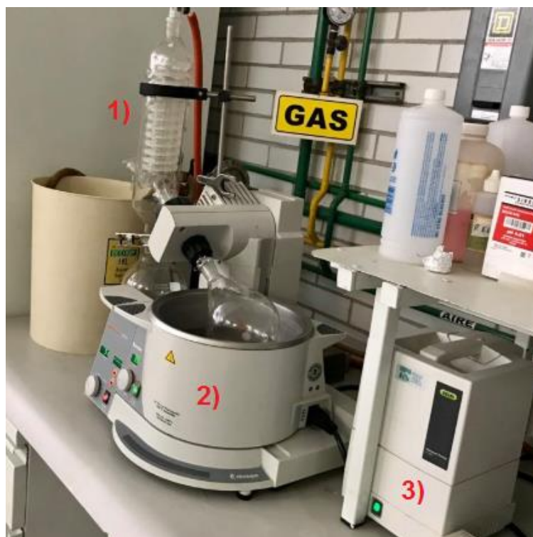
Figura 28. Sistema de rotavapor (1. Refrigeración, 2. Baño termostático, 3. Sistema al vacío)
