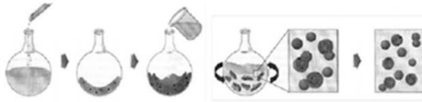
Figura 15. Esquema de la formación de liposomas método Brangham: preparación de la disolución, formación de la película, hidratación y extrusión (Cuerda-Correa., 2005)
