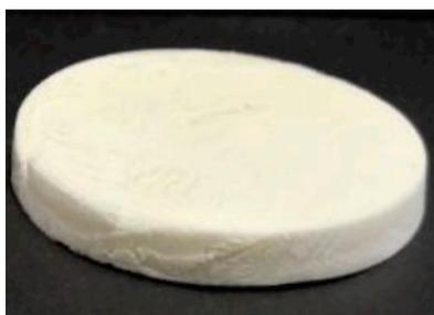
Figura 11. Espuma sólida hecha a base de SPI y celulosa bacteriana (Zhang et al., 2020).
