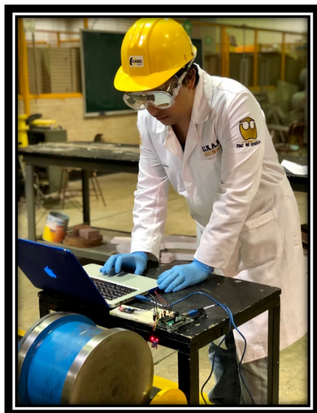
Figura No. 5 Sistema de medición de intensidad Arduino adaptado al sistema de molienda.
