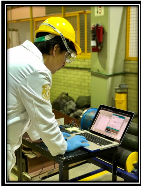
Figura No. 8 Medición y registro del sonido en el sistema Arduino-computadora al molino de bolas.
