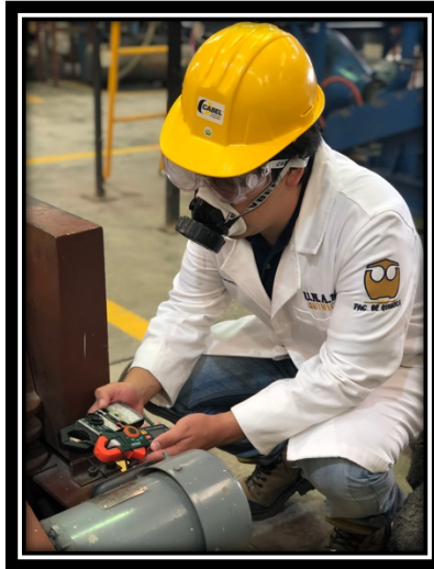
Figura No 6. Medición de Amperaje sobre el motor de la trituradora, en la determinación del índice del trabajo ( W_i ) del mineral de calcopirita.
