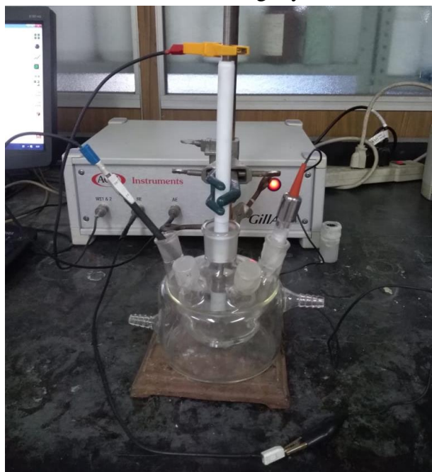
Figura 2.1 Sistema de trabajo para realizar pruebas estáticas
