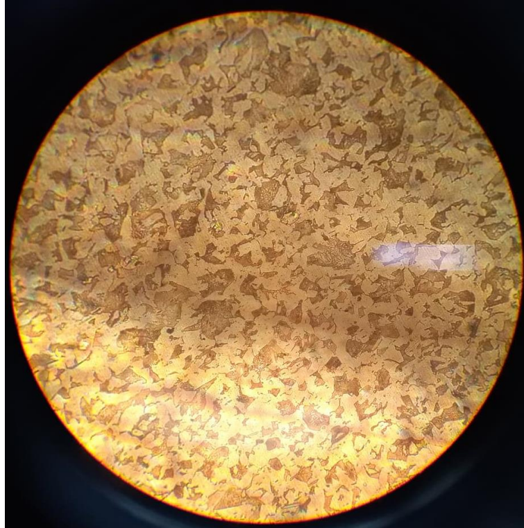
Figura 3.2 Metalografía realizada a 400 aumentos atacada con Nital 2 por 5 segundos.
