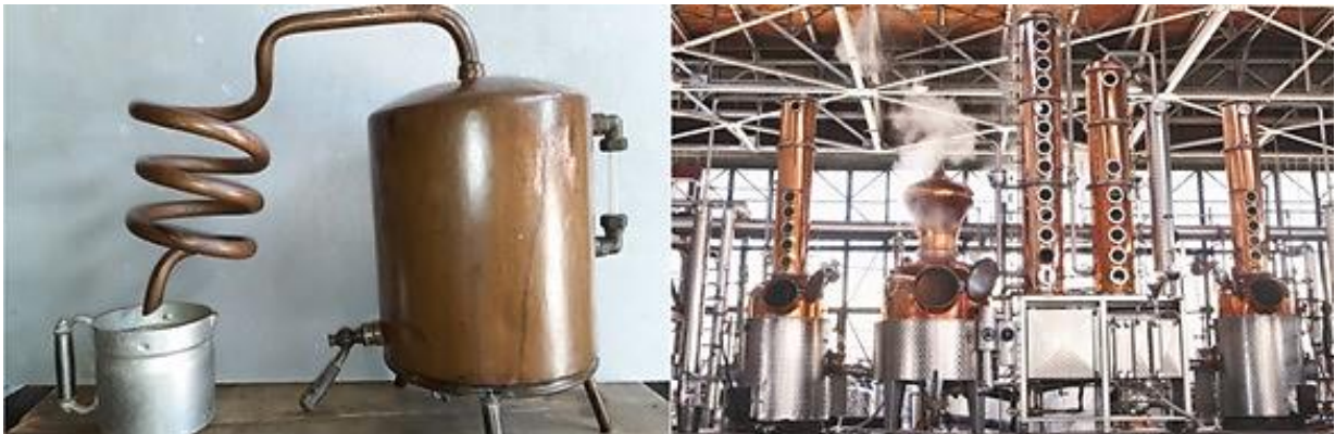
Figura 4. Alambiques para destilación a escala casera e industrial Tomada de: (Microlab Industrial, 2019)
