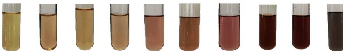
Imagen 1C. Aumento en la coloración en presencia de metanol en las bebidas alcohólicas
