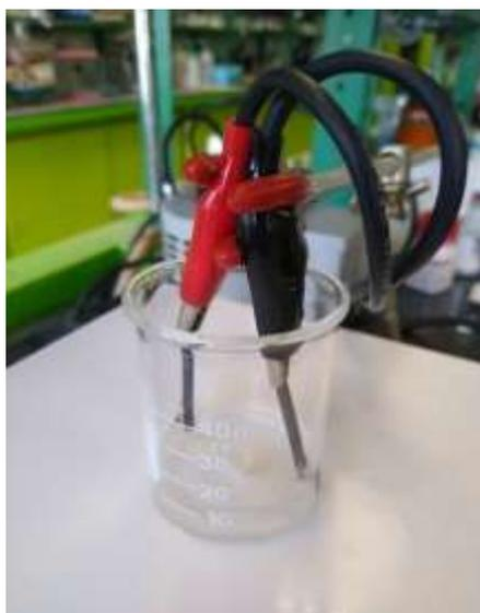
**Figura 17.** Reacción empleando electrosíntesis con electrodos de grafito.
