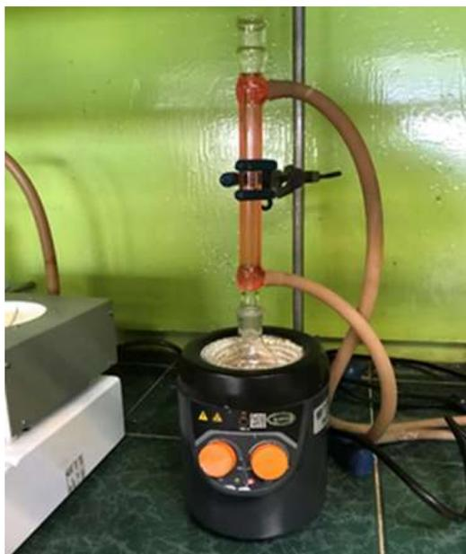
**Figura 18.** Reacción empleando energía térmica en condiciones de reflujo.
