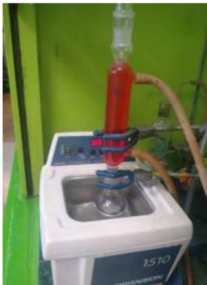
**Figura 14.** Reacción activada por ultrasonido en la caba ultrasónica
