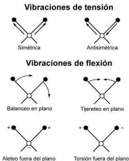
**Figura 10.** Modos de vibración en moléculas: flechas indican dirección y magnitud de movimientos; signos +,- indican movimientos hacia arriba y abajo perpendicular a la página.
