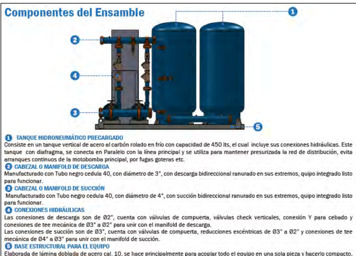
Imagen 81 Equipo hidroneumático Duplex propuesto para el hotel, Fuente: Manual de especificaciones Valsi, 2021
