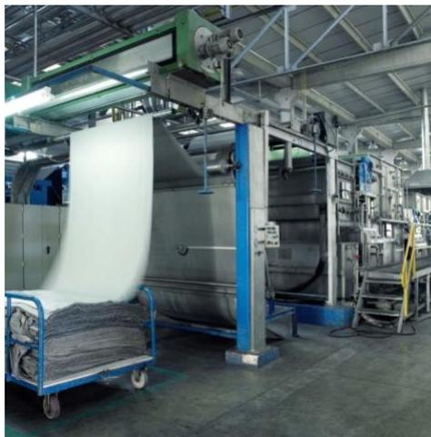
*Figura 10. Máquina de planchado textil.
