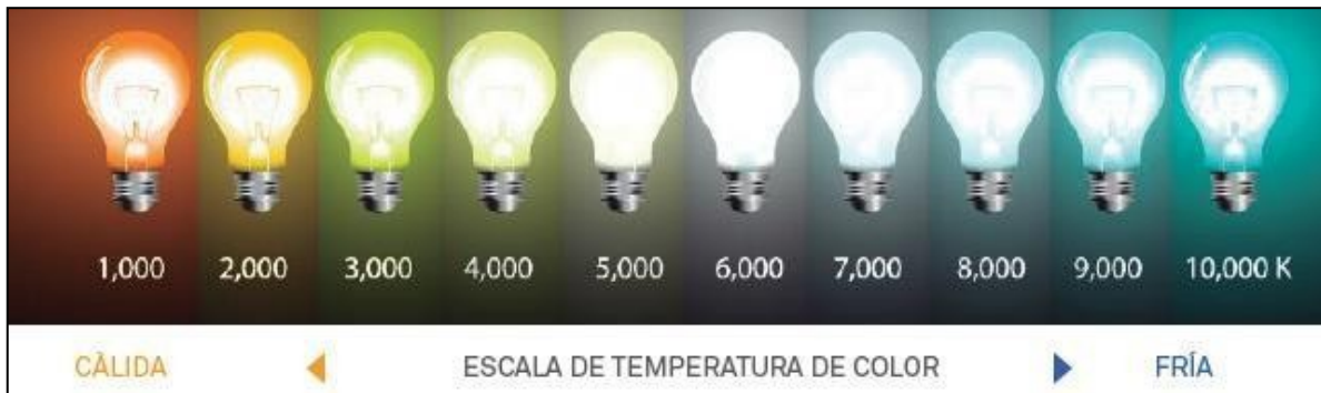
Figura 2.7.- Escala de Temperatura de color.
