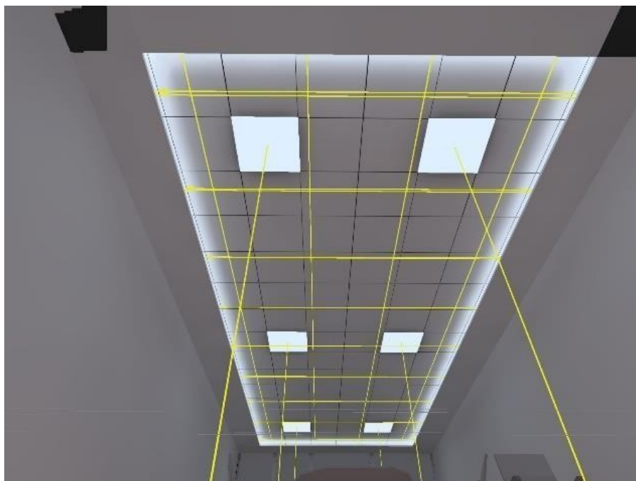
Figura 6.6.- Distribución de luminarias Sala de Juntas.
