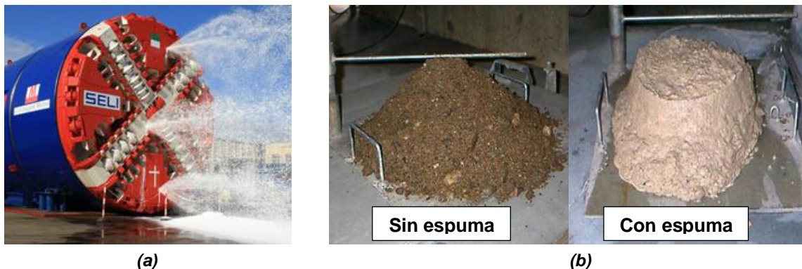
Figura 5.19 (a) Inyección de espuma a través de la rueda de corte; (b) Comparación de material acondicionado con uso de espuma. Tomado de (Reynolds, 2021), (Peila, 2010)
