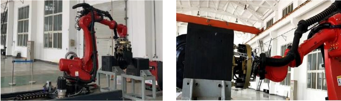
Figura 5.30 Robot para cambio de herramienta, sistema IIRTT. Tomado de (Gangqiang, 2019)
