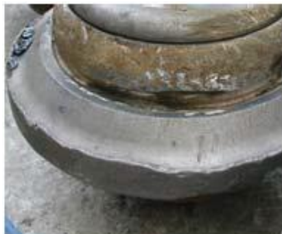
Figura 5.12 Deformaciones plásticas en discos. Tomado de (Pérez Fernández, 2018)
