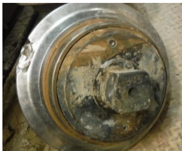
Figura 5.11 Aro astillado. TEO, Tramo IV
