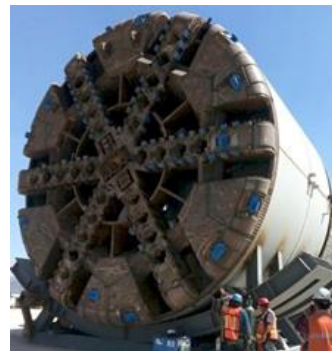
Figura 7.2 Configuración de la rueda de corte de la TBM-EPB S-209 "Morelos". Tomado de (LYTSA Lumbreras y Túneles, 2021)
