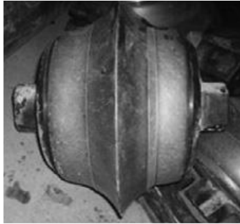
Figura 5.14 Auto-afilado en disco. Tomado de (Farrokh & Kim, 2018)
