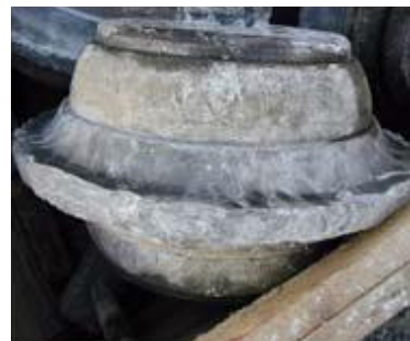
Figura 5.11 Aro astillado. TEO, Tramo IV
