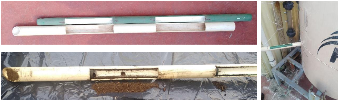
Figura 3.12 Nucleador para toma de muestras de composta
