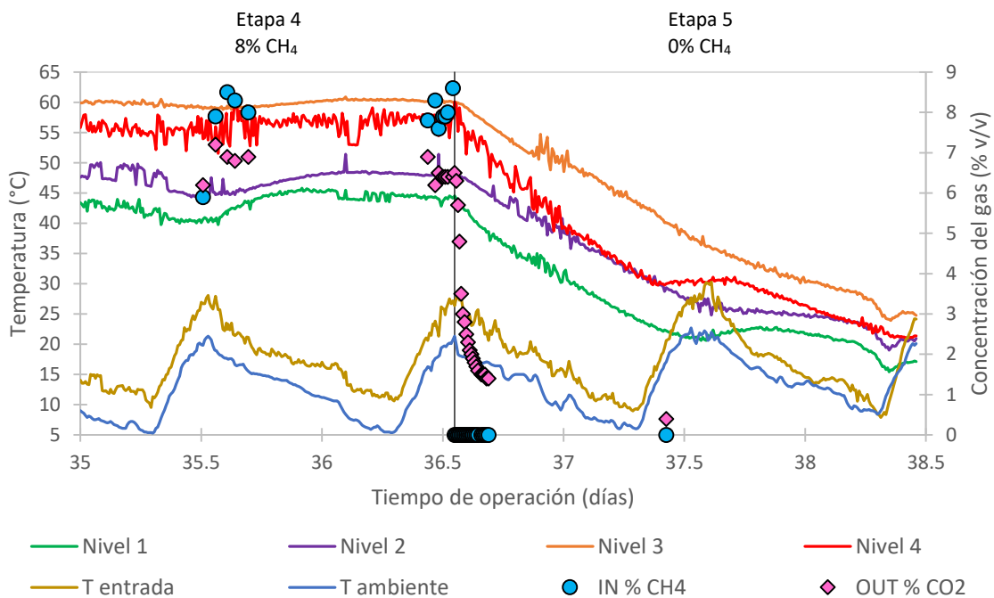
Figura 4.18 Temperatura registrada en el centro del biofiltro en los niveles de altura 1 (0.05m), 2 (0.15m), 3 (0.35 m) y 4 (0.50m) con y sin alimentación de CH 4 en la corriente de aire
