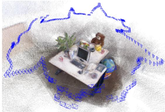
Figura 2.1: Ejemplo de estimación de posición usando localización y mapeo simultáneos con imágenes. Los polígonos azules representan el sistema de referencia de la cámara respecto de un sistema global de coordenadas. Los puntos coloreados son píxeles reproyectados en el sistema global de coordenadas (imagen tomada de [10]).
