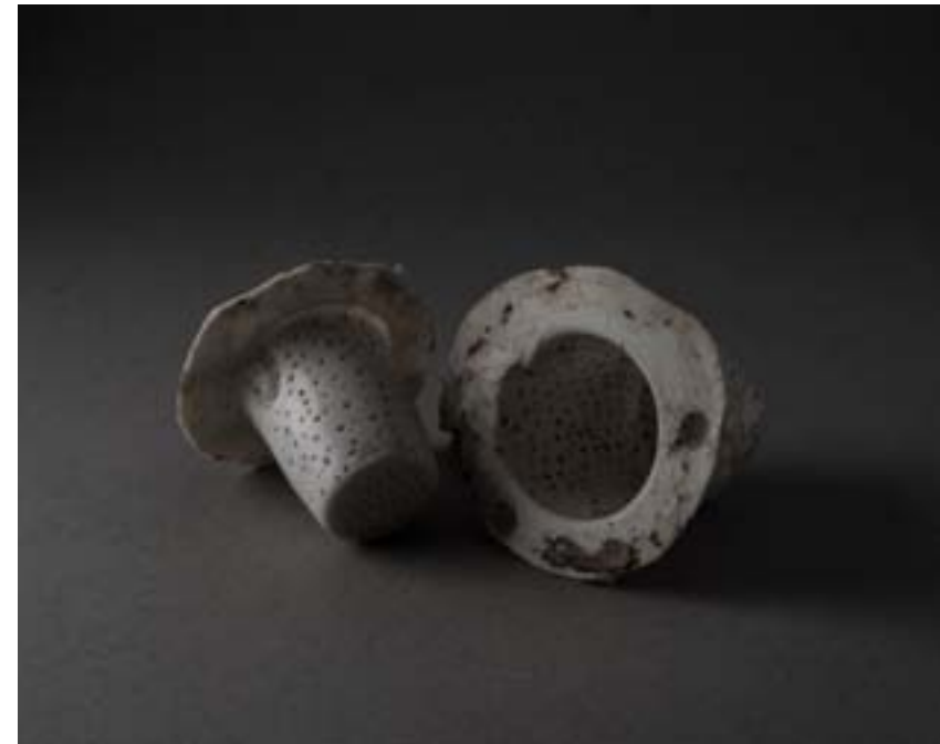
Fotos de molde 2 de yeso y silicon 1. Molde embozado abierto 2. Molde cerrado 3. Molde de silicon interno abierto
