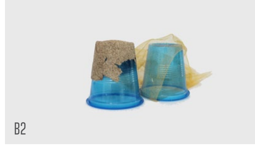
muestra B2 partes macho - hembra del molde de plástico con una muestra de la malla sintético utilizado para el desmolde.
