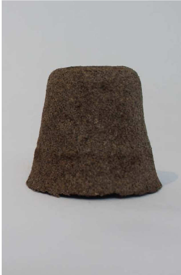
resultado último de molde interior de silicón y exterior de yeso.
