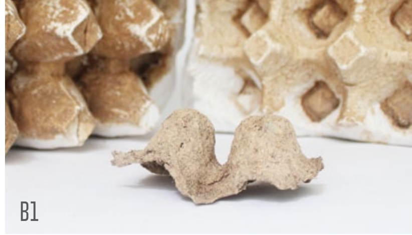
zoom a experimento B1 molde de yeso de dos partes macho - hembra con malla sintético como capa divisoria
