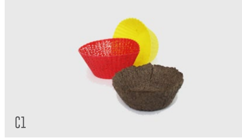
muestra C1 molde de ods paartes, cho-hembra con silicon como capa intermedia para conformación y desmolde
