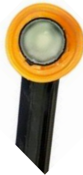
Figura 11. Punta de Unidad LED Monowave (Fuente propia)
