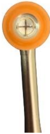
Figura 12. Punta de Unidad LED Poliwave (Fuente propia)
