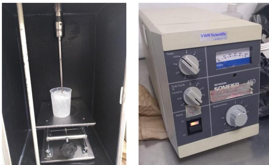
Figura 25. Sonicator Branson. Izquierda: cámara de sonicador y derecha: Fuente de poder.
