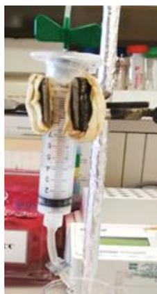
Figura 18. Columna de purificación.
