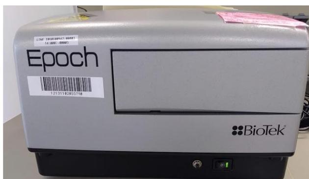
Figura 20. Espectrofotómetro Epoch™ BioTek®.
