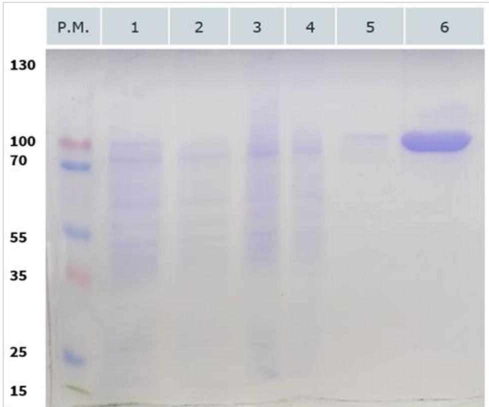
Figura 40. Gel de electroforesis SDS-PAGE al 10%. Tinción con Coomassie coloidal. Los carriles corresponden a: 1. Sonicado 20 ug ( $\beta$ -mercaptoetanol), 2. Sonicado 10 ug ( $\beta$ -mercaptoetanol), 3. Ag. Sonicado 20 ug, 4. Ag. Sonicado 10 ug, 5. Ag. Choque térmico 10 ug, 6. Sobrenadante de cultivo sin albúmina.
