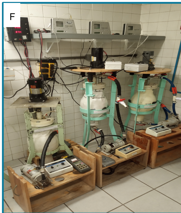
Termohidrolizador de lodos (E) y digestores anaerobios (F) en operación dentro del cuarto a temperatura controlada en el Laboratorio de Ingeniería Ambiental (LIA) del Instituto de Ingeniería de la UNAM.
