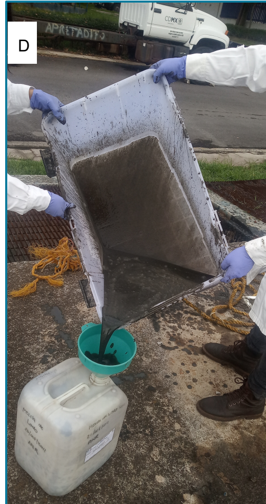
Punto de muestreo de lodo primario (A y B) en Planta de Tratamiento de Aguas Residuales “Cerro de la Estrella”. Tamizaje y embalaje de lodo primario (C y D).
