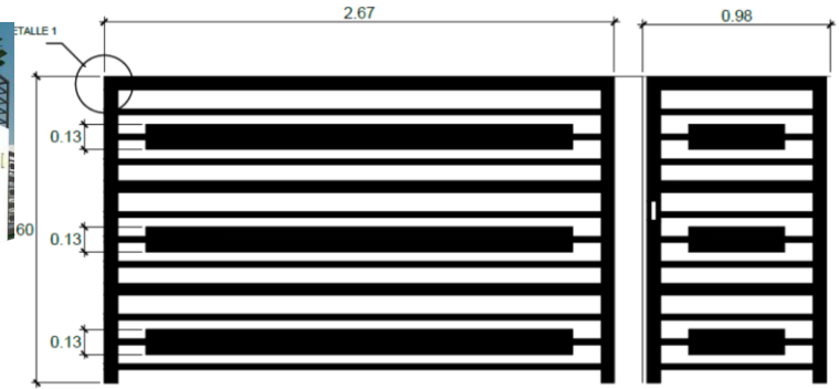
Figura 126. Detalle de herrería de portones. Plano de elaboración propia, 2017. Plano HER, véase pág. 165.
