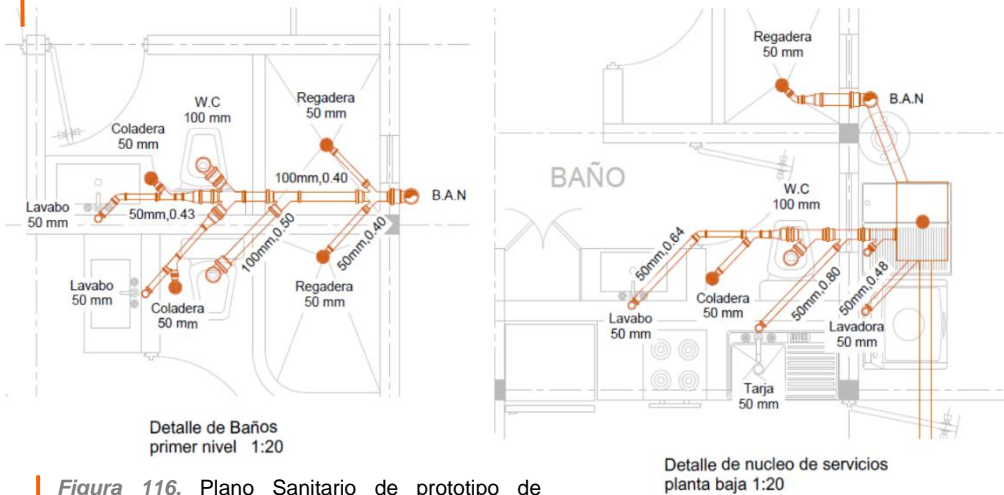
Figura 116. Plano Sanitario de prototipo de vivienda B. Plano de elaboración propia, 2017. Plano INS-SA, véase pág. 180.
