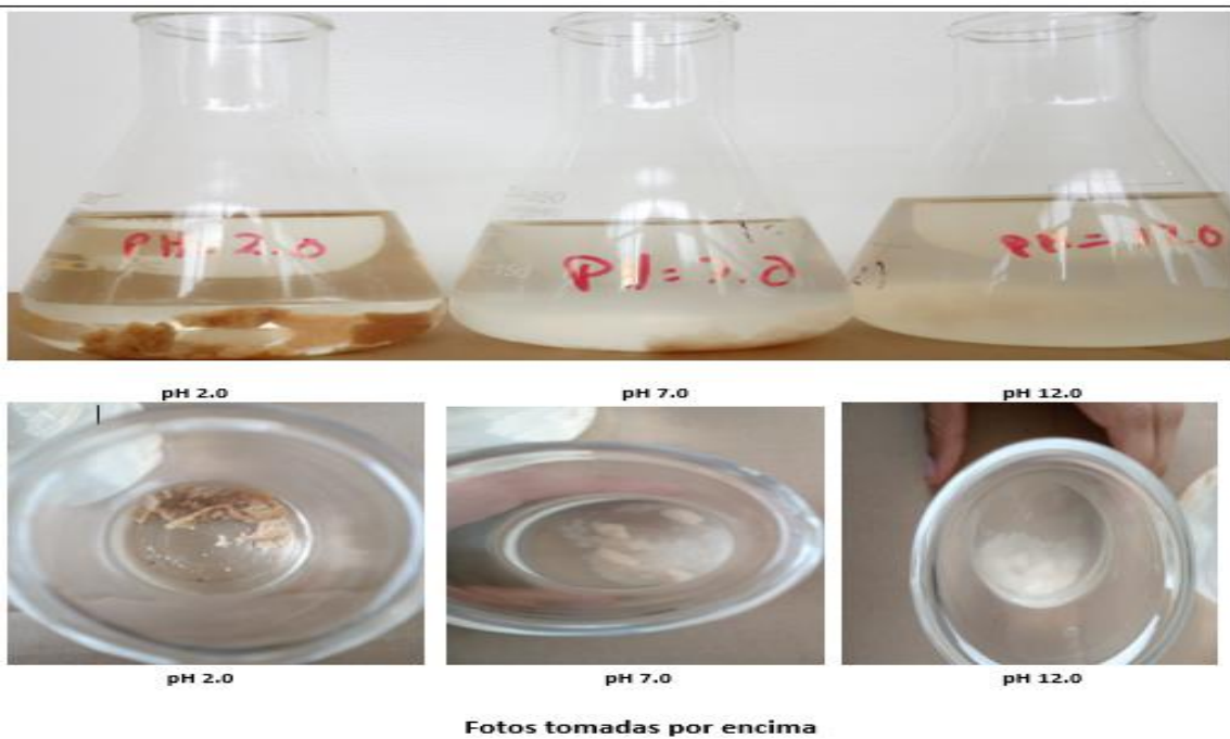
Figura 40. Materiales plastificados obtenidos a partir del almidón de la semilla de yuca.
