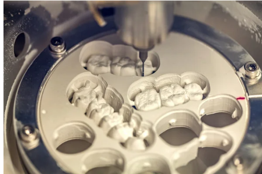
Fig 69. Fresado de los diseños previamente realizados. 57 Tomado de: https://n9.cl/nqc95h
