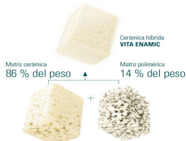
Fig 40. Composición de Vita Enamic. 14 Tomado de: t.ly/YYxs
