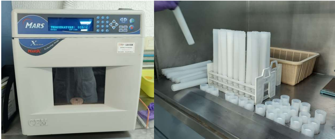
Figura 10. Equipo de digestión por microondas MARS XPRESS (izquierda) y tubos de teflón (derecha) donde se llevó a cabo la digestión de la biomasa microalgal.
