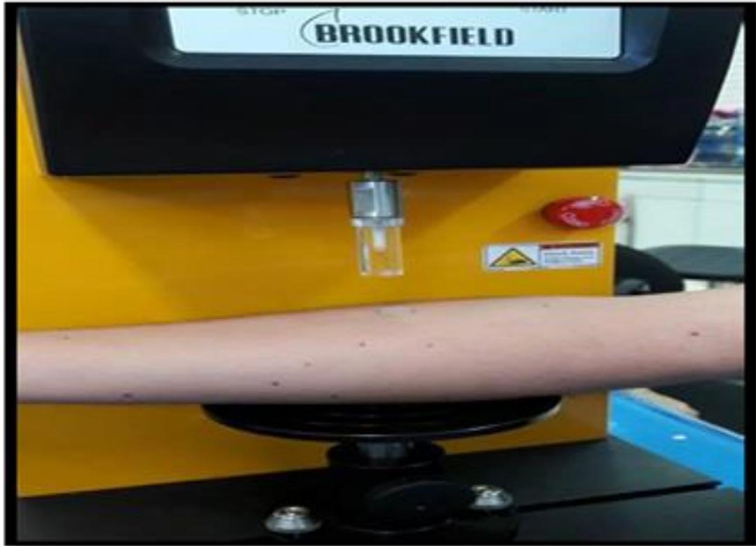
*Figura 21. Evaluación de la bioadhesión de los parches transdérmicos realizada en un texturómetro Brookfield CTB Texture Analyzer<sup>21</sup>*
