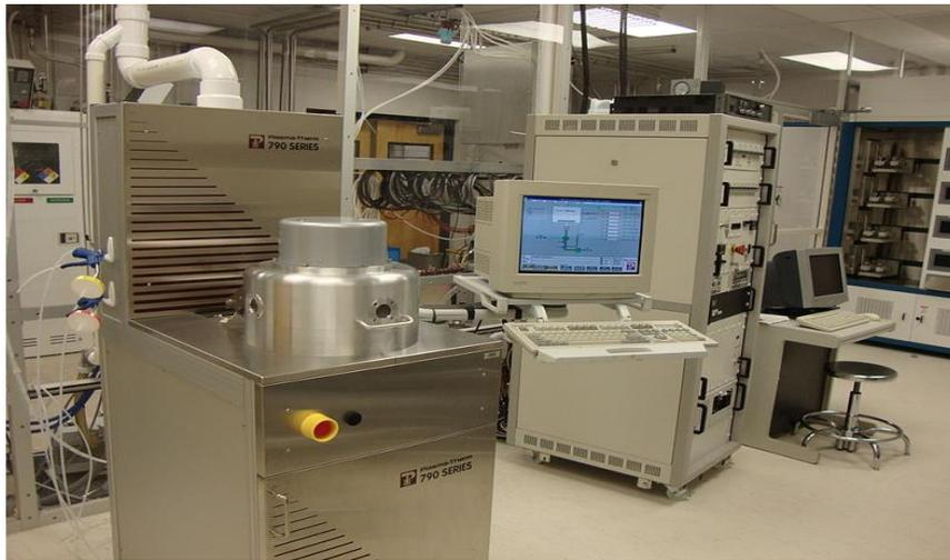
*Figura 11. Equipo para grabado por ion reactivo<sup>11</sup>*
