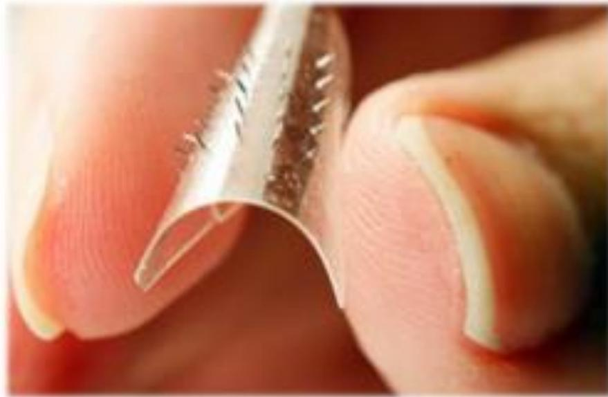
*Figura 1. Microagujas sobre un soporte polimérico <sup>1</sup>*
