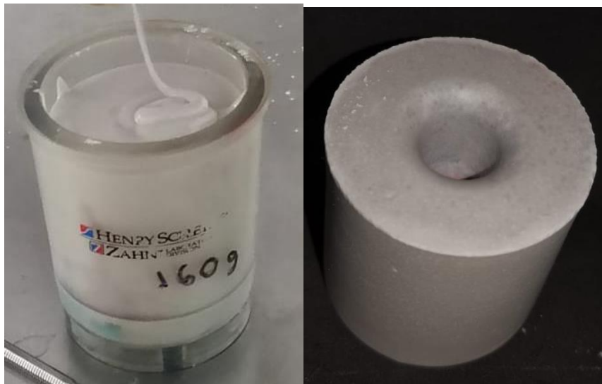
Figura 47. Se llena el cubilete y se espera a que fragüe. (FD)
