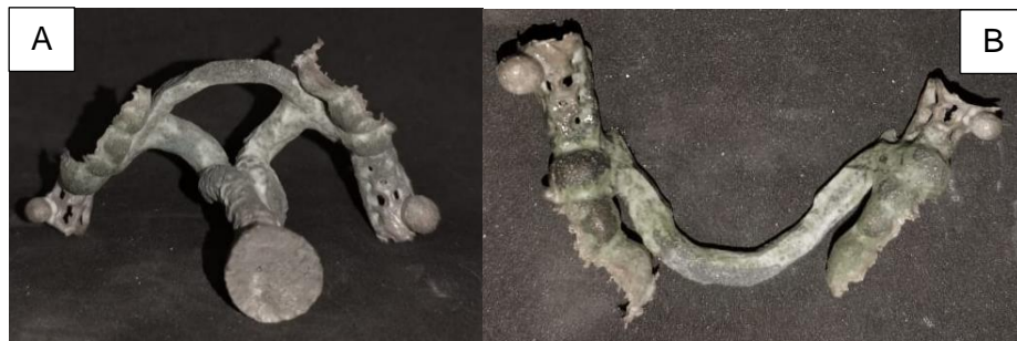
Figura 63. A) Armazón recién obtenido B) Armazón después del arenado. (FD)
