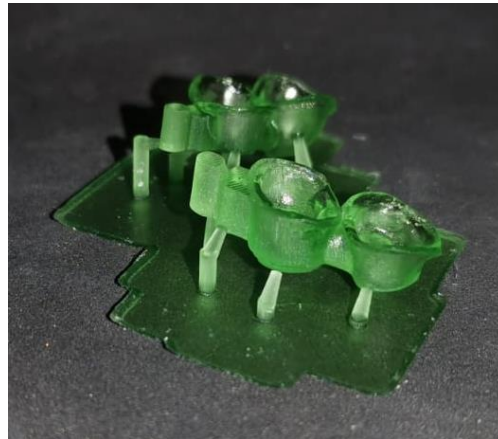
Figura 82. Impresiones 3D después de ser limpiadas con alcohol. (FD)
