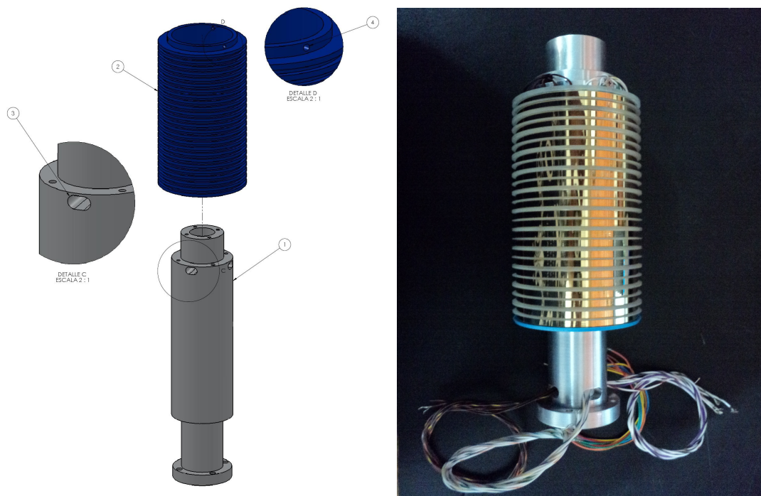
Figura 5.21: Ensamble del anillo deslizante a la columna, 1) columna central, 2) anillo deslizante, 3) ranura para cableado eléctrico, 4) orificio para tornillo de sujeción del anillo deslizante.
