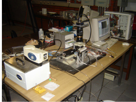
Figura 3.4: Sistema de dos velocímetros por imágenes de partículas para analizar la convección natural en una cavidad cilíndrica.
