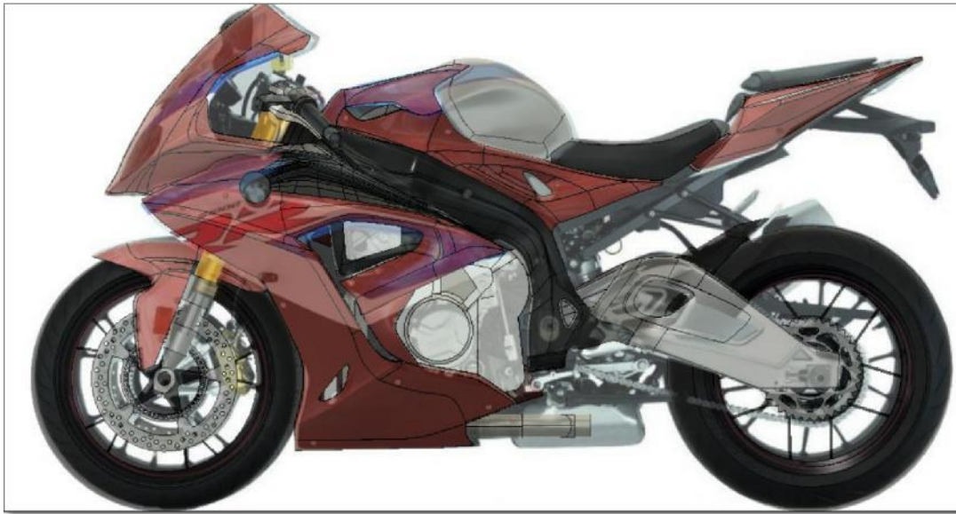
Figura 61 - Modelado por comando "Form" de sistema de carenado y chasis
