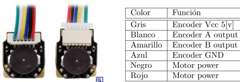
Figura A.3: Conexión de los motores
