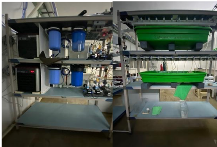
Figura 2. Sistema de control de temperatura utilizado para el mantenimiento de los juveniles de O. maya que se utilizaron como organismos focales aclimatados a dos temperaturas (24 y 30 °C).
