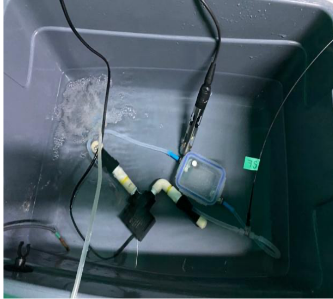
Figura 5. Sistema experimental de control de temperatura utilizado para la medición de TM_{max} y TM_{min} , empujando el método TIMR, en los juveniles focales de O. maya aclimatados a dos temperaturas.
