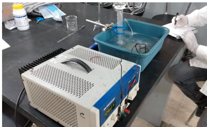
Ilustración 3.3.2. Montaje del equipo de electrólisis.
