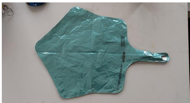
Ilustración 3.2.2. Globo metálico empleado para extracción y transporte de muestras de Biogás.
