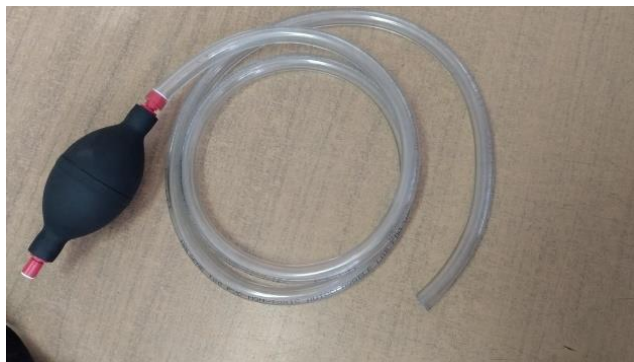
Ilustración 3.2.1. Sonda empleada para la extracción de Biogás.
