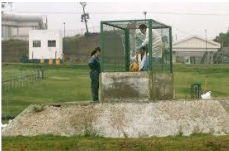
Ilustración 3.2.3. Personal técnico de monitoreo ambiental realizando las tareas de monitoreo y extracción de una muestra de Biogás.
