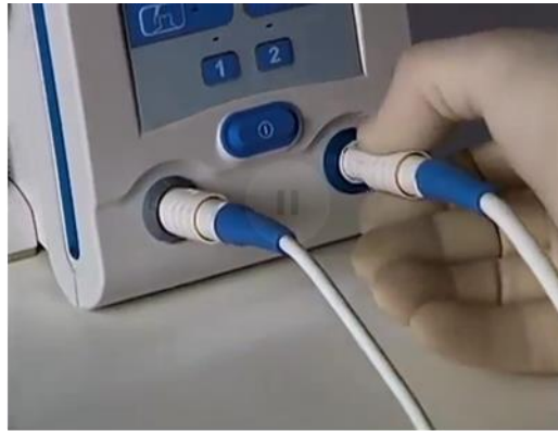
Figura 61. Conexión de los cables de las piezas de mano a la consola. Tomada de: Desntsply Sirona Endodontics USA. https://bit.ly/37wdXIR
