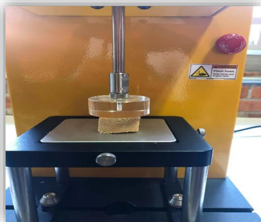
Figura 16. Texturómetro brookfield (determinación de parámetros texturales)
