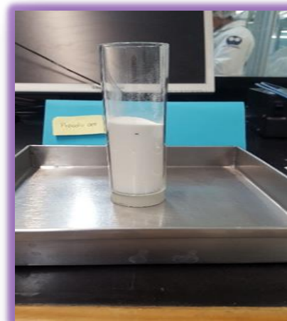
Figura 22. Charola de acero inoxidable 20 x 20 cm, con un cilindro de vidrio y un tapón de hule para determinar el ángulo de reposo.
