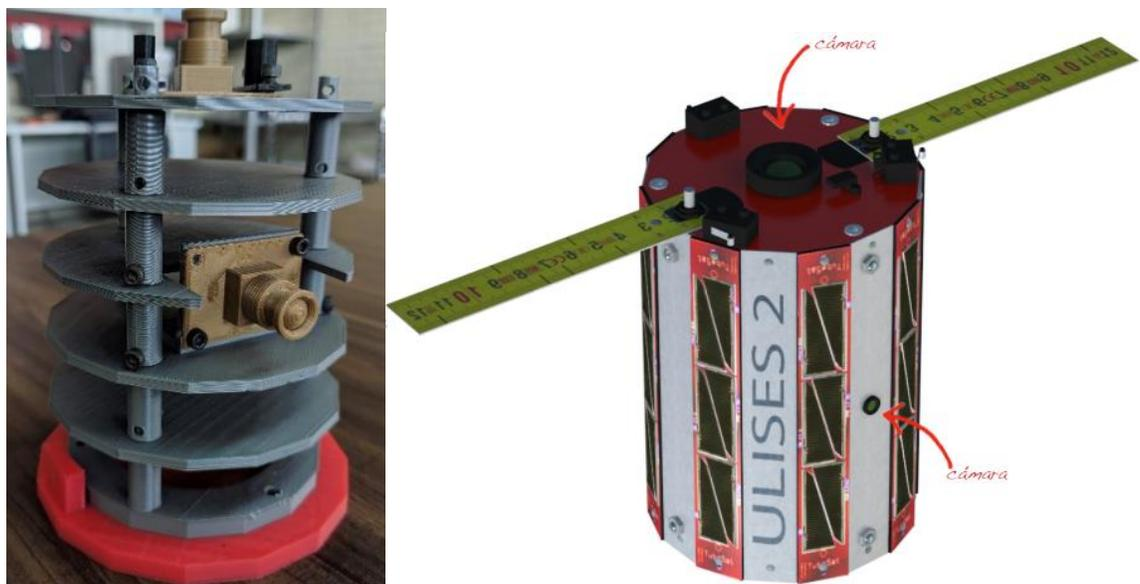
Figura 2.3. Modelo teórico del KuauhtliSAT impreso en 3D (izquierda) y prototipo inicial (derecha) (crédito de imagen: UAT-FI-UNAM)
