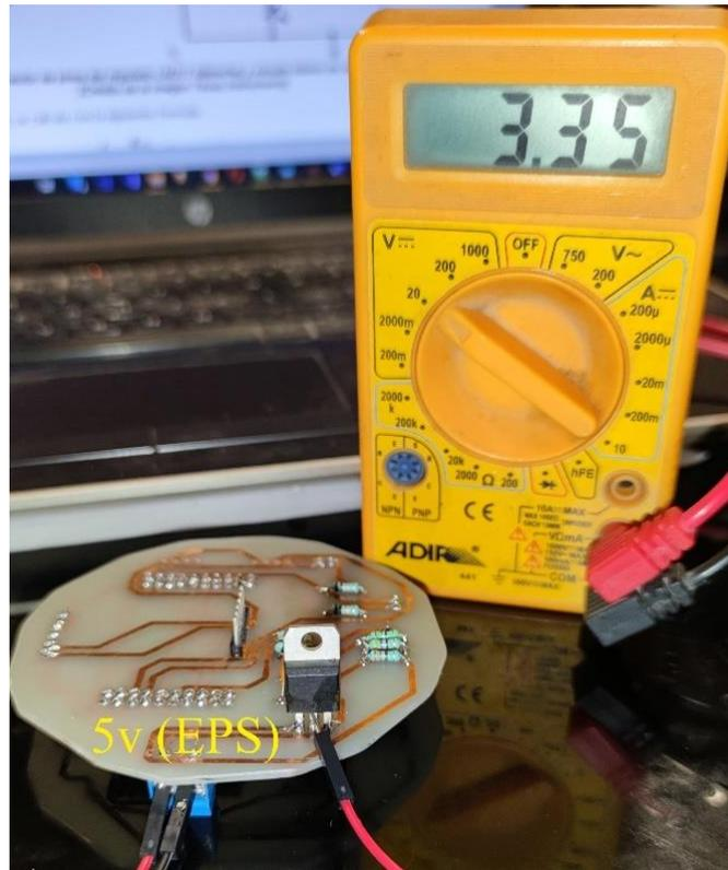
*Figura 4.13. Validación de la generación de la línea de voltaje a 3.3v con el regulador LM317*
