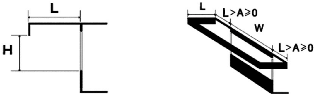
Ilustración 15 Ejemplo de Volado Sobre la Ventana con extensión lateral hasta los límites de ésta identificando todas las dimensiones que hay que tomar en cuenta (CONUEE, 2001)
