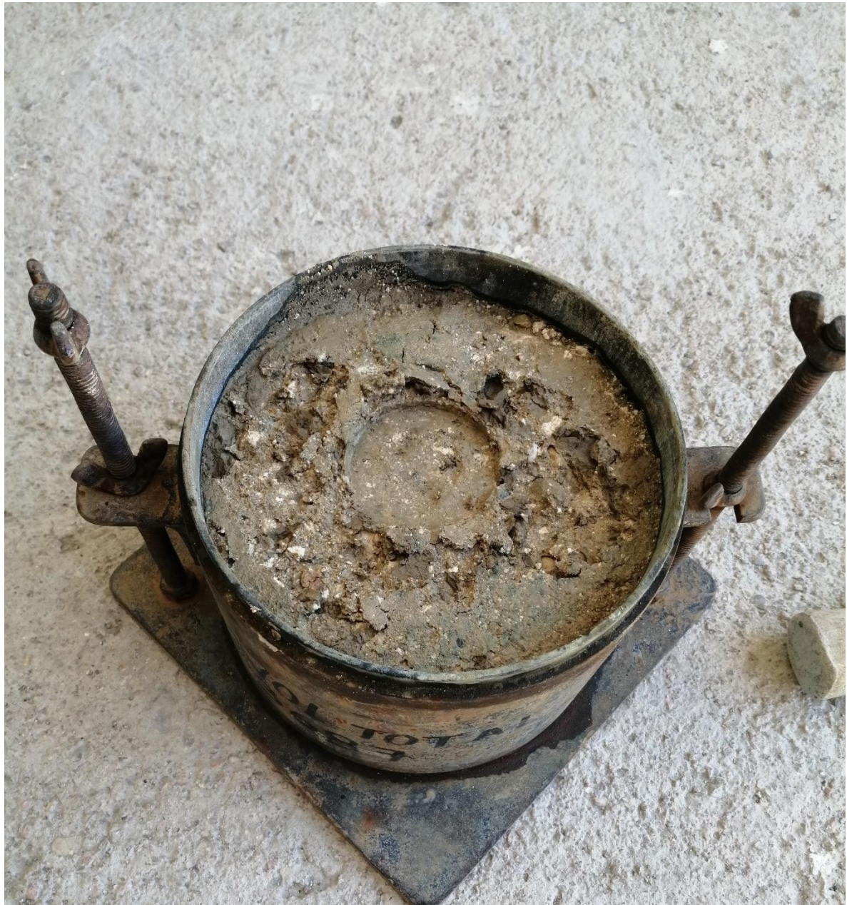
Figura26 Material compactado de las pruebas realizadas mezcla arcilla- caliche. (Laboratorio del Ingeniero José Inocente Espinoza Vicente, ubicado en Suchiapa, Chiapas).
