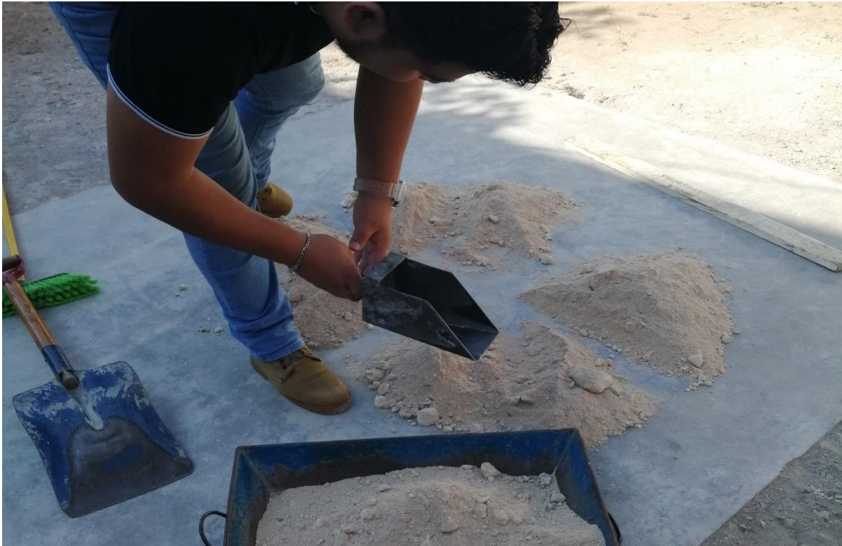
Figura18. Caliza alterada color café claro a tono blanco. Proceso de cuarteo y colocación homogénea del material para el uso en laboratorio para mezclas con arcilla. (Laboratorio del Ingeniero José Inocente Espinoza Vicente, ubicado en Suchiapa, Chiapas).
