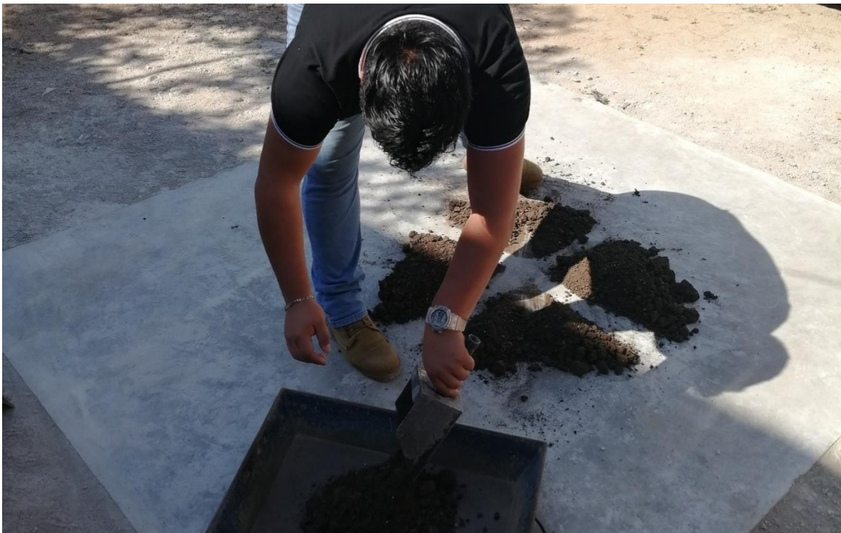
Figura19. Procedimiento de cuarto ahora con material arcilloso para su mejoramiento en las pruebas mecánicas. proceso de cuarto y homogenización. (Laboratorio del Ingeniero José Inocente Espinoza Vicente, ubicado en Suchiapa, Chiapas).
