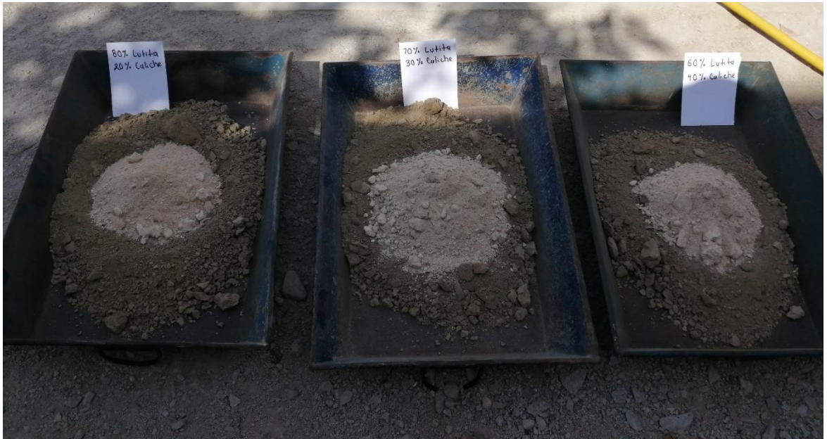
Figura20. Mezclas utilizadas para la obtención de pruebas mecánicas de laboratorio/ suelo estabilizado. Mezcla: arcilla lutita 80%- caliche 20% / arcilla lutita 70% - caliche 30% / arcilla
