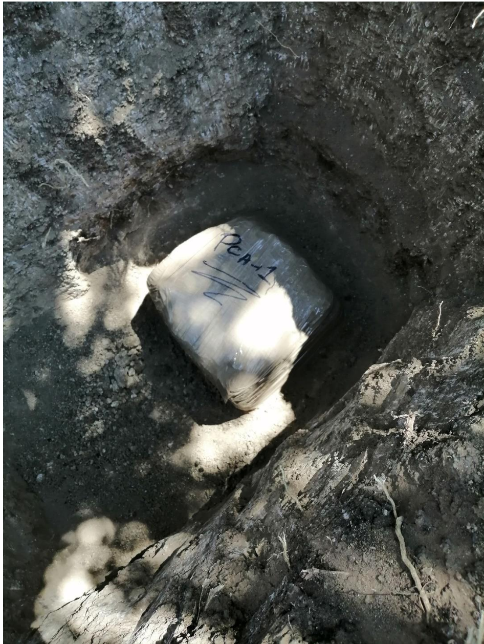
Figura 13. Cubo de material; arcilla de alta plasticidad extraída para prueba de laboratorio en base a la estabilización de suelos expansivos. (Tuxtla Gutiérrez Chiapas - Suchiapa 16^{\circ}38'23.9'' N 93^{\circ}06'00.4'' ).
