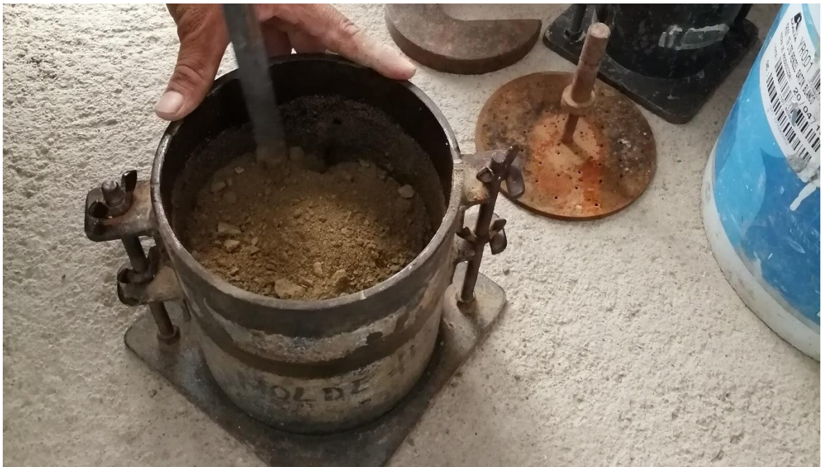
Figura23. Llenado de recipiente Proctor aplicando 25 golpes en cada capa con varilla punta de bala. Con esto se recrea la compactación en el lugar. (Laboratorio del Ingeniero José Inocente Espinoza Vicente, ubicado en Suchiapa, Chiapas).
