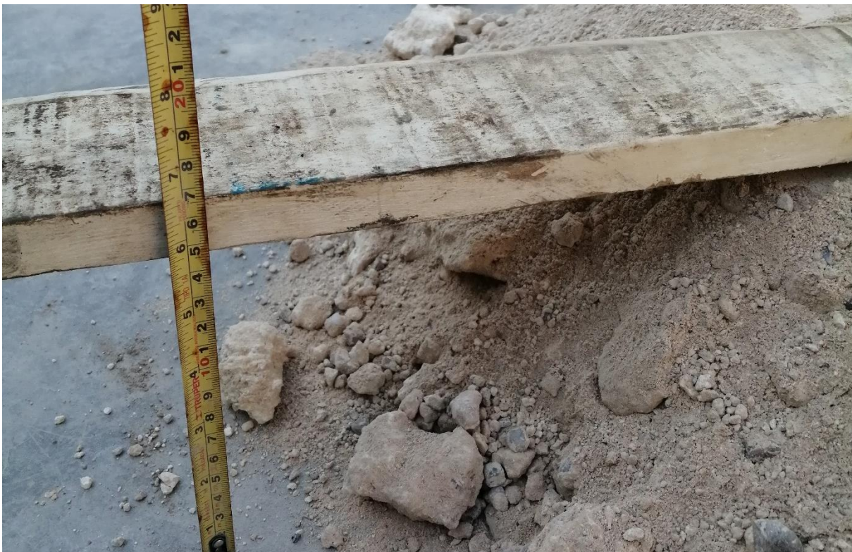
Figura17. Caliza alterada color café claro a tono blanco. medición del cono a 15 cm para la ejecución del método de cuarteo. (Tuxtla Gutiérrez Chiapas - Suchiapa 16°38'23.9" N 93°06'00.4")
