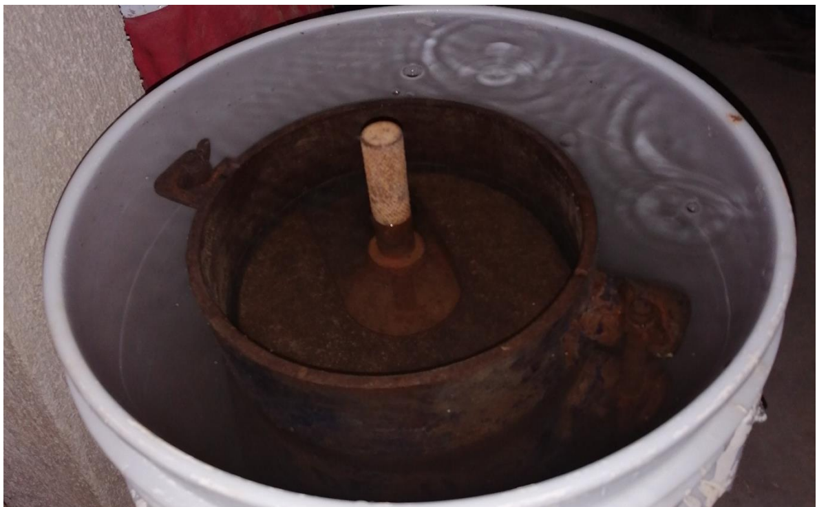
Figura25. Molde y material sumergido para la obtención del grado de hinchamiento. (Laboratorio del Ingeniero José Inocente Espinoza Vicente, ubicado en Suchiapa, Chiapas).
