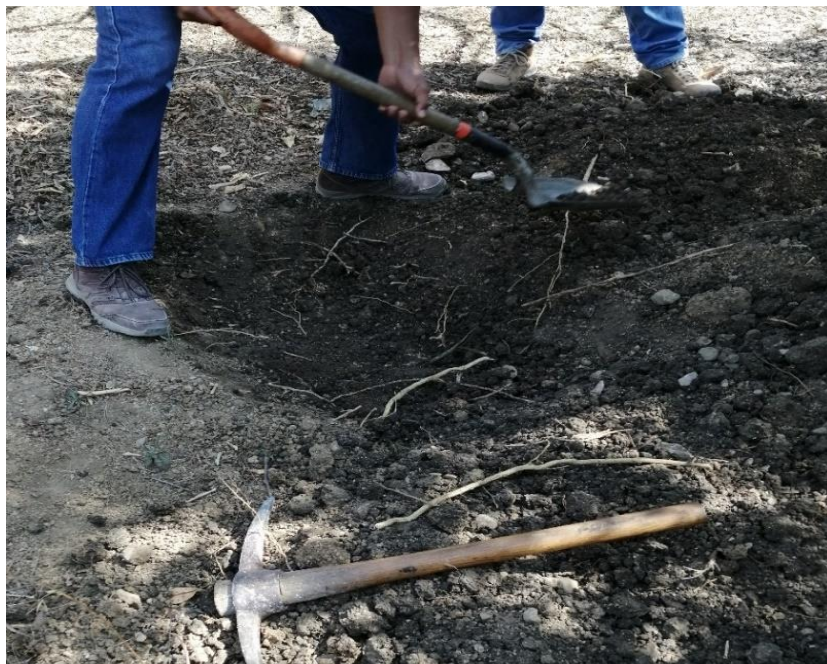
Figura 12. Localización del sitio y extracción de material, con una profundidad de 1.5 m x 1 m, con el uso manual de herramientas como son: barreta, pala, guantes, flexómetro, barreta. (Tuxtla Gutiérrez Chiapas - Suchiapa 16°38'23.9" N 93°06'00.4").
