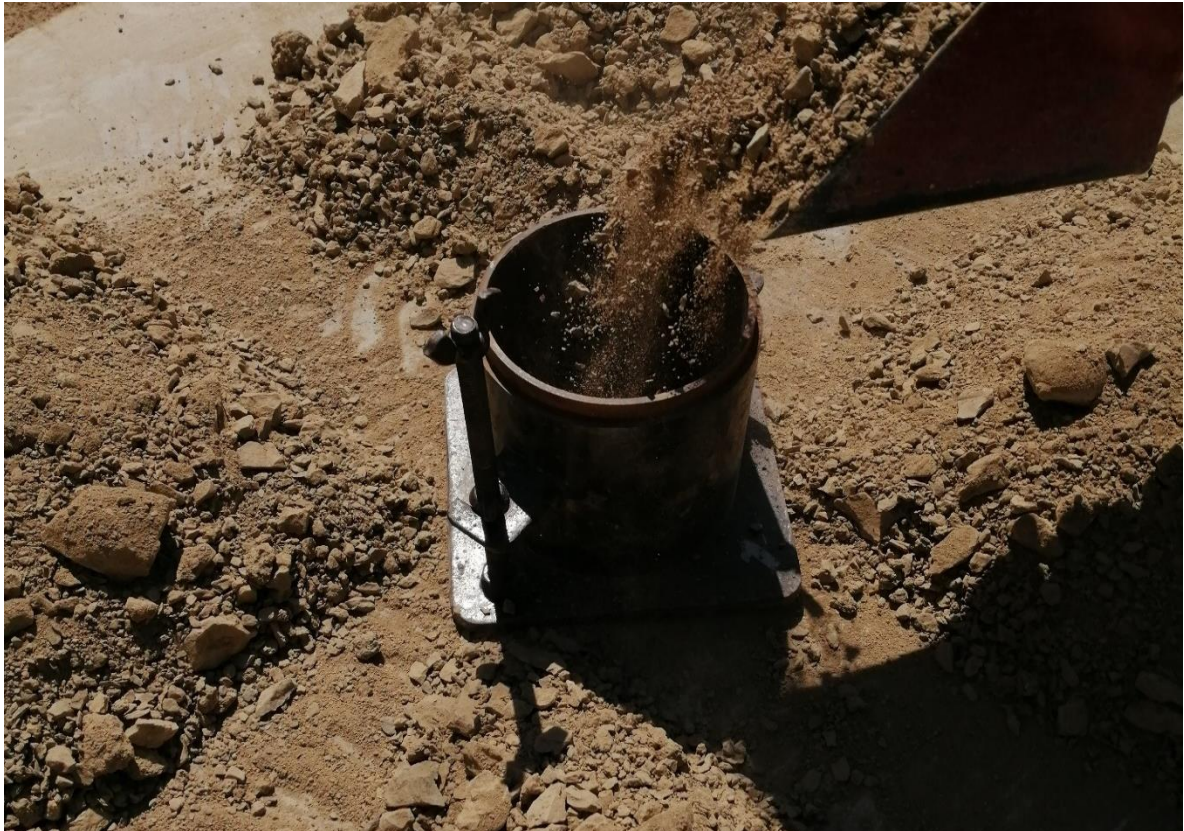
Figura22. Realización de cuartero y llenado de recipiente para la prueba Porter estándar de las mezclas realizadas arcilla- caliche. (Laboratorio del Ingeniero José Inocente Espinoza Vicente, ubicado en Suchiapa, Chiapas).
