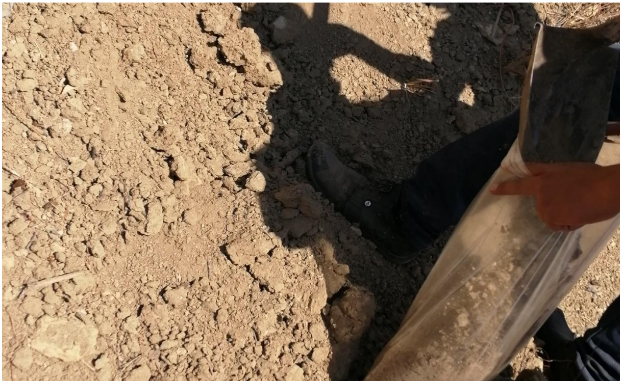
Figura15. Para mezclas de laboratorio: arcilla tipo lutita/color café/ uso para el mejoramiento de ella, aplicando el uso de caliche. (Tuxtla Gutiérrez Chiapas - Suchiapa 16°38'23.9" N 93°06'00.4").
