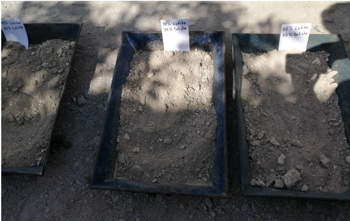
Figura21. Mezclas homogenizadas correctamente para estudios de mecánica de suelos. Mezcla: arcilla lutita 80%- caliche 20% / arcilla lutita 70% - caliche 30% / arcilla lutita 60% - caliche 40%. (Laboratorio del Ingeniero José Inocente Espinoza Vicente, ubicado en Suchiapa, Chiapas).
