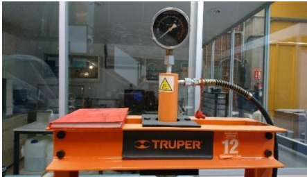
5.14 Prensa marca Truper 12 toneladas, IF/UNAM
