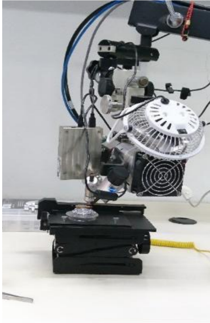
5.21 Sistema de Fluorescencia de Rayos X portátil SANDRA
