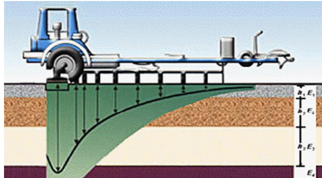
ILUSTRACIÓN 10 ARREGLO DE SENSORES EN EL EQUIPO; FUENTE: MANUAL DE INICIO RÁPIDO FWD - DYNATEST
