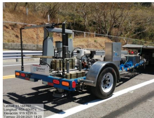
ILUSTRACIÓN 4 EQUIPO DE IMPACTO FWD. FUENTE: YUTAVE INGENIERIA, SA DE CV
