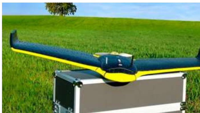
Figura 9. Drone de ala fija. Recuperado de https://surveyrental.com
