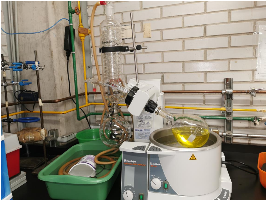
Figura 9. Montaje de destilación con rotavapor. Fotografía original Laboratorio de Farmacognosia (UBIPRO, FES Iztacala).
