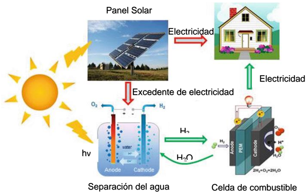
Figura 5. Esquema de la producción de hidrógeno mediante energía solar.
