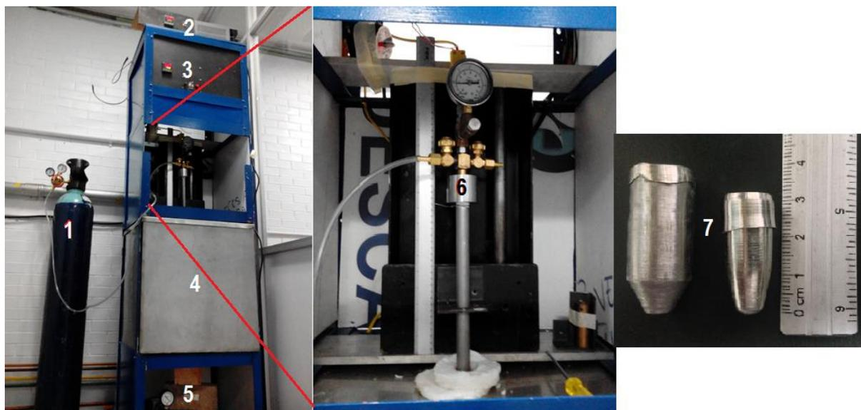
**Figura 2.1** Sistema de síntesis. (1) tanque de gas Argón, (2) control de temperatura del termopar del reactor, (3) control de temperatura del termopar del horno, (4) horno vertical, (5) bomba de vacío, (6) reactor de síntesis y (7) celdas de platino.
