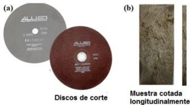
Figura 32. (a) Disco de corte marca Allied; (b) Representación gráfica del corte longitudinal de los lingotes de la aleación Fe-Mn para su posterior caracterización.
