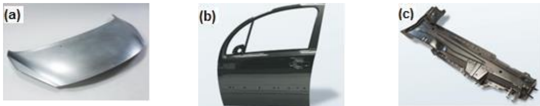
Figura 10. Los aceros de la gama BH están diseñados para piezas visibles como capó (a), puerta (b), viga longitudinal (c), entre otros como el portón trasero, alerón delantero, techo; al igual que para estructurales que pueden ser bajos, refuerzo, travesaño, revestimiento [6]. En este caso, (a) expone el capó en CR180BH, (b) puerta en CR240BH, y (c) la viga longitudinal delantera en CR270BH.
