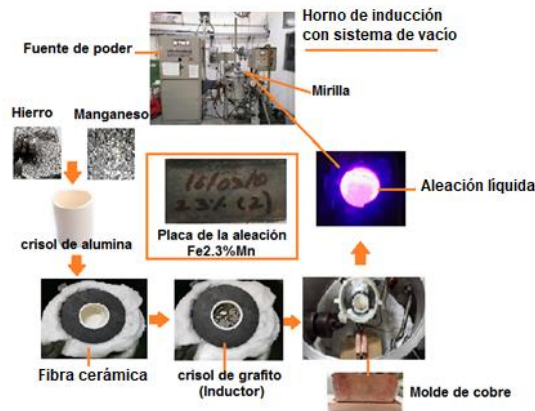
Figura 29. Proceso de fusión, colada del metal líquido en molde de cobre rectangular y solidificación de la aleación Fe 2.3 Mn. Se muestra la composición del montaje experimental que permitió obtener las placas de la aleación Fe 2.3 Mn con las dimensiones: 10 cm de largo, 5 cm de ancho y 7 mm de espesor.
