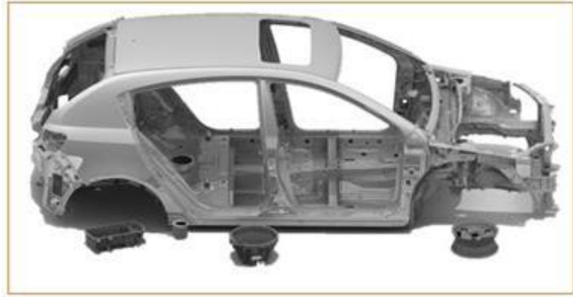
Figura 3. Aplicación automotriz de acero con bajo contenido de carbono en componentes de carrocería en formas estructurales, su contenido de carbono entre 0.05% y 0.25% que lo hace maleable y dúctil [2], permitió proponer formas de vehículos más atractivos, así como hacerlos accesibles económicamente para la época de su desarrollo. Destaca que las estructuras como ésta se hacían de un solo lienzo, esta situación se modificó conforme el desarrollo de nuevos materiales y exigencias del mercado.
