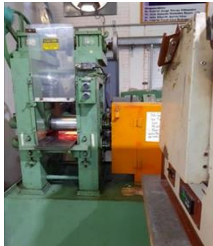
Figura 31 Se aprecia el laminador FENN 5-MILL al momento de llevarse a cabo la laminación de la placa de acero Fe2.3Mn previo a su proceso de corte y tratamientos térmicos.
