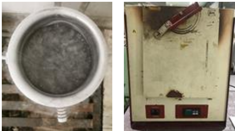
Figura 33. Del lado izquierdo se aprecia el tratamiento térmico subcero consistente en llevar a -180^{\circ}\text{C} el acero por medio de nitrógeno líquido durante 6 horas y del lado derecho se aprecia el tercer tratamiento térmico que fue el relevado de esfuerzos.
