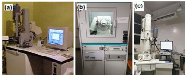
Figura 34. Elementos necesarios para el proceso de caracterización y los ensayos mecánicos: (a) Microscopio electrónico de barrido ( Leica-Stereoscan ); (b) Difractómetro de rayos-x ( Siemens D-5000 ); (c) Microscopio electrónico de transmisión.
