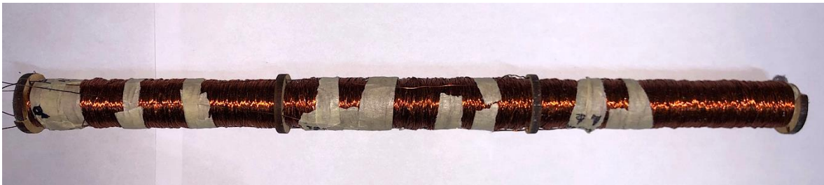
Figura 3.9 Bobinas a lo largo de tubo guía con separación de 3 mm entre ellas.
