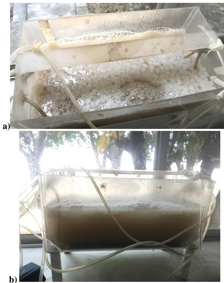
Figura 2-9. Reactores en continuo con biomasa inmovilizada en medios de soporte Kaldnes-K1, a) vista superior y b) vista lateral
