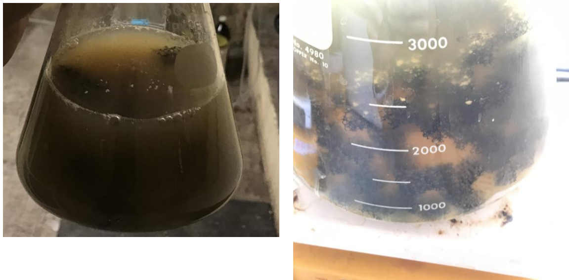
Figura 2-5. Crecimiento de biomasa en cubos de poliuretano (pH=9.5 unidades, temperatura=27°C, agitación=120 rpm, Vútil=3 L)
