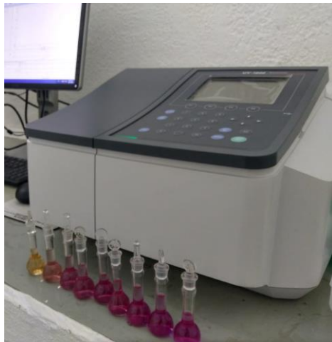
Figura 7-1. Desarrollo de color en las curvas de calibración para la medición de cianuro mediante espectrofotometría
