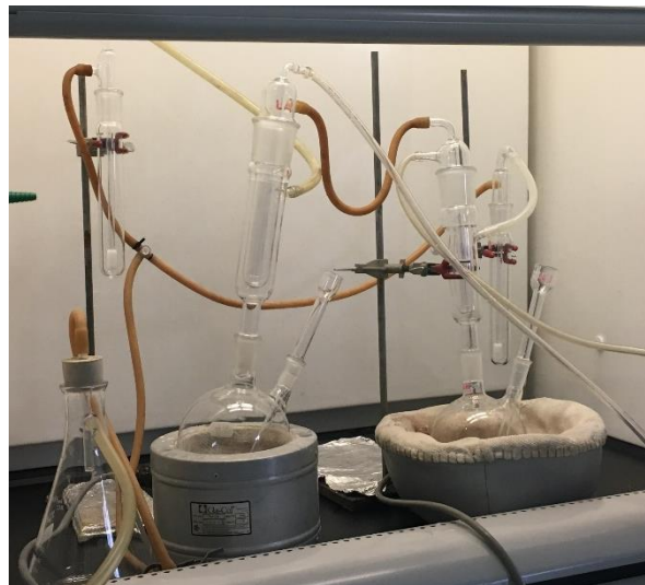
Figura 7-2. Destilación por reflujo de muestras cianuradas
