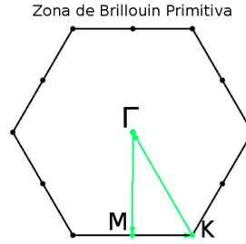
Figura 4.1: Trayectoria dentro de la primer zona de Brillouin de una red hexagonal.  $\Gamma$ ,  $M$  y  $K$  son puntos de alta simetría y delimitan la zona irreducible de Brillouin marcada por las líneas verdes.
