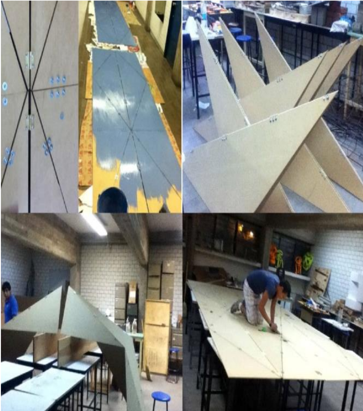
Ilustración 40: © Guerra Martínez Roberto Carlos, fotografías. Estructura plegada. Taller de maquetas, Taller Ehecatl XXI Los jóvenes hicieron las siguientes deducciones: Si la maqueta manipulada en clase, no se deformaban los triángulos en las que se descomponía la cubierta, podrían fabricar cada pieza, fijarlas y colocarles las bisagras según el pliegue definido y ya que la escala seleccionada permite que se pueda cargar por una persona, se arma un módulo autoportante y al final ensamblar en sitio cada módulo.
