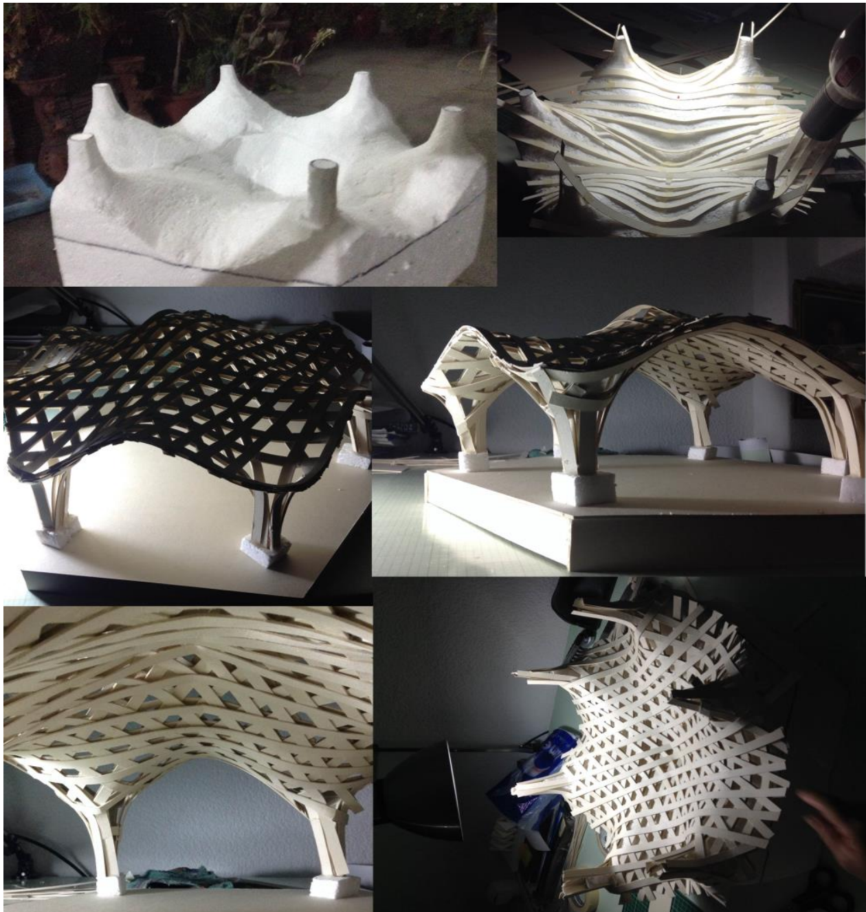
Ilustración 44: © Delgadillo Acevedo Oswaldo, Fotografías: Experimento para la aproximaciones en el manejo de una superficie alabeada, realizando un modelo en negativo con unicel y obre esta colocando un entramado del cual se obtiene la forma con cuatro apoyos, se puede apreciar dificultad en la transición de curva a rectas y la falta de continuidad entre una barra a otra, pero es un buen ejemplo para determinar una primera imagen para un objeto arquitectónico.
