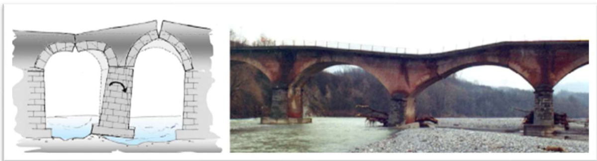
Figura 2.18- Falla por el mecanismo de multiarco debida a la socavación (Brenchich, A., 2007).
