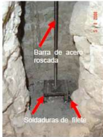
Figura 5. 8- Refuerzo vertical efectuado al interior de una torre de un modelo a escala (Chávez M, 2010).
