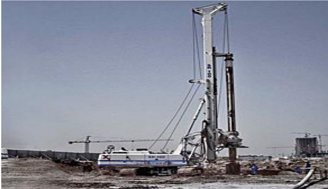
Imagen 2.1. Equipo para pilotaje
