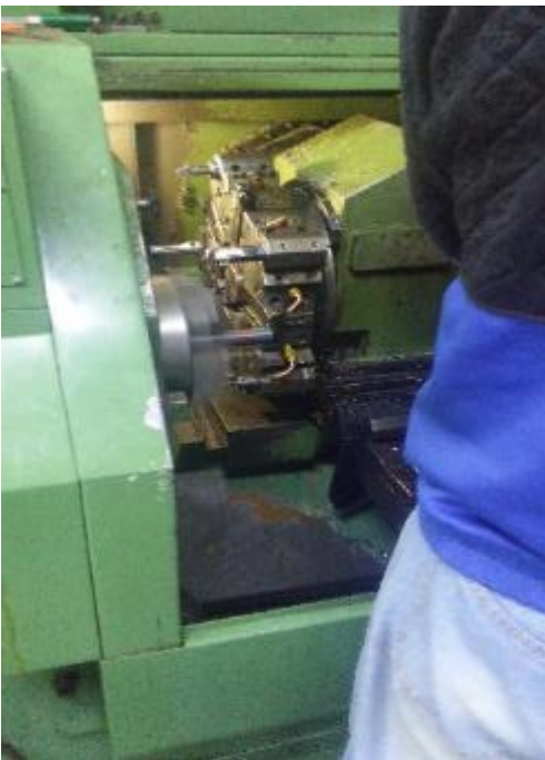
Fig.92.- Maquinado en torno CNC.
