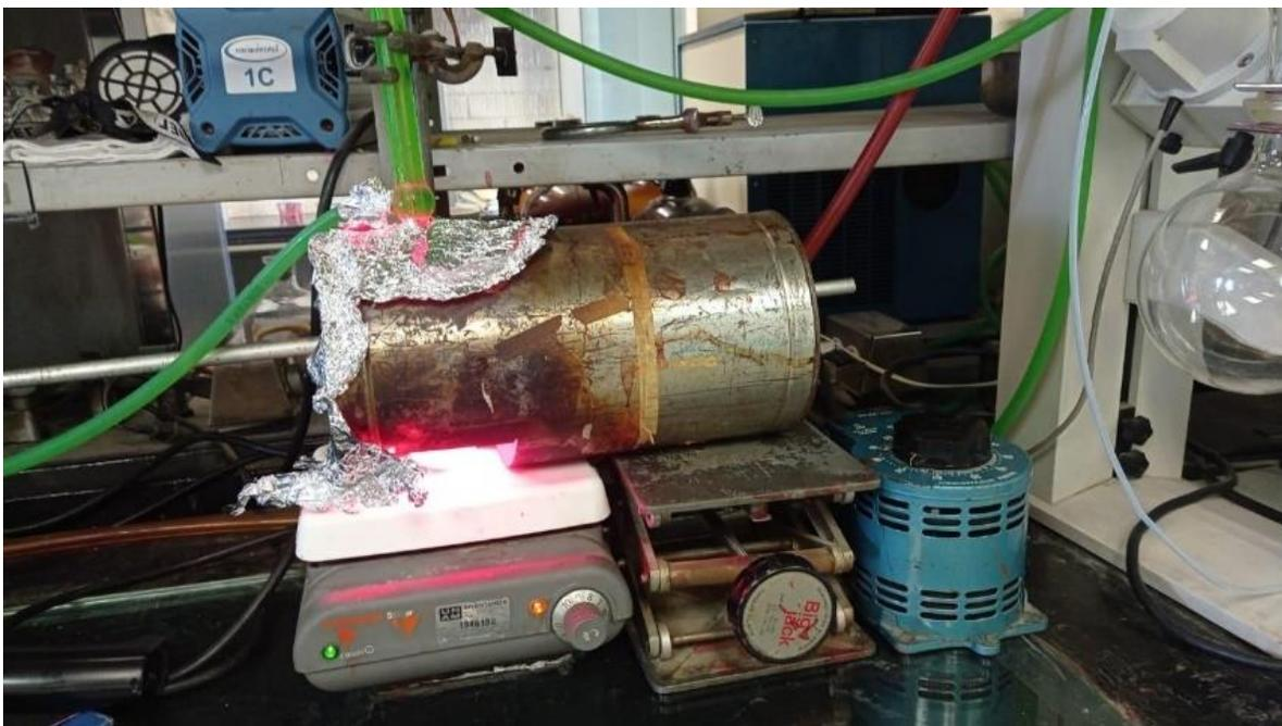
Figura 13. Sistema de reacción de radiación infrarroja
