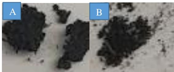
Figura 19. A) nanotubos de multipared sin funcionalizar (MWNTC-V) y B) nanotubos de multipared funcionalizados con ácido carboxílico (MWNTC-COOH).
