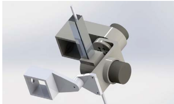
Figura 2.4: Mecanismo de desplazamiento lineal del sistema eScope .
