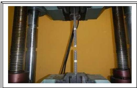
Imagen. 13 Ensayo a tensión de varilla corrugada.
