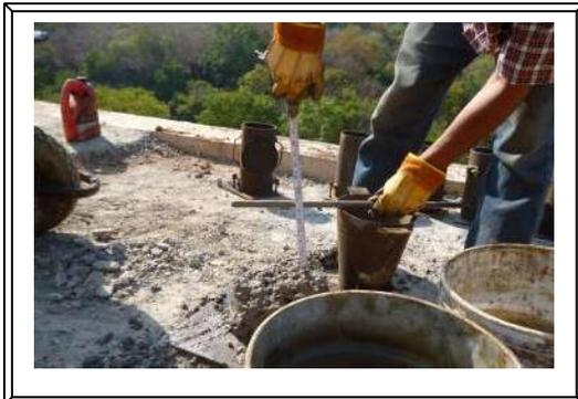
Imagen. 11 Prueba de revenimiento de concreto.
