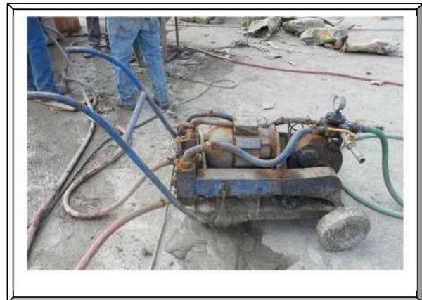
**Imagen.129 Inyectora de lechada.**
