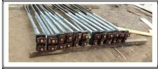
**Imagen. 77** Anclaje pasivo monotorón.
